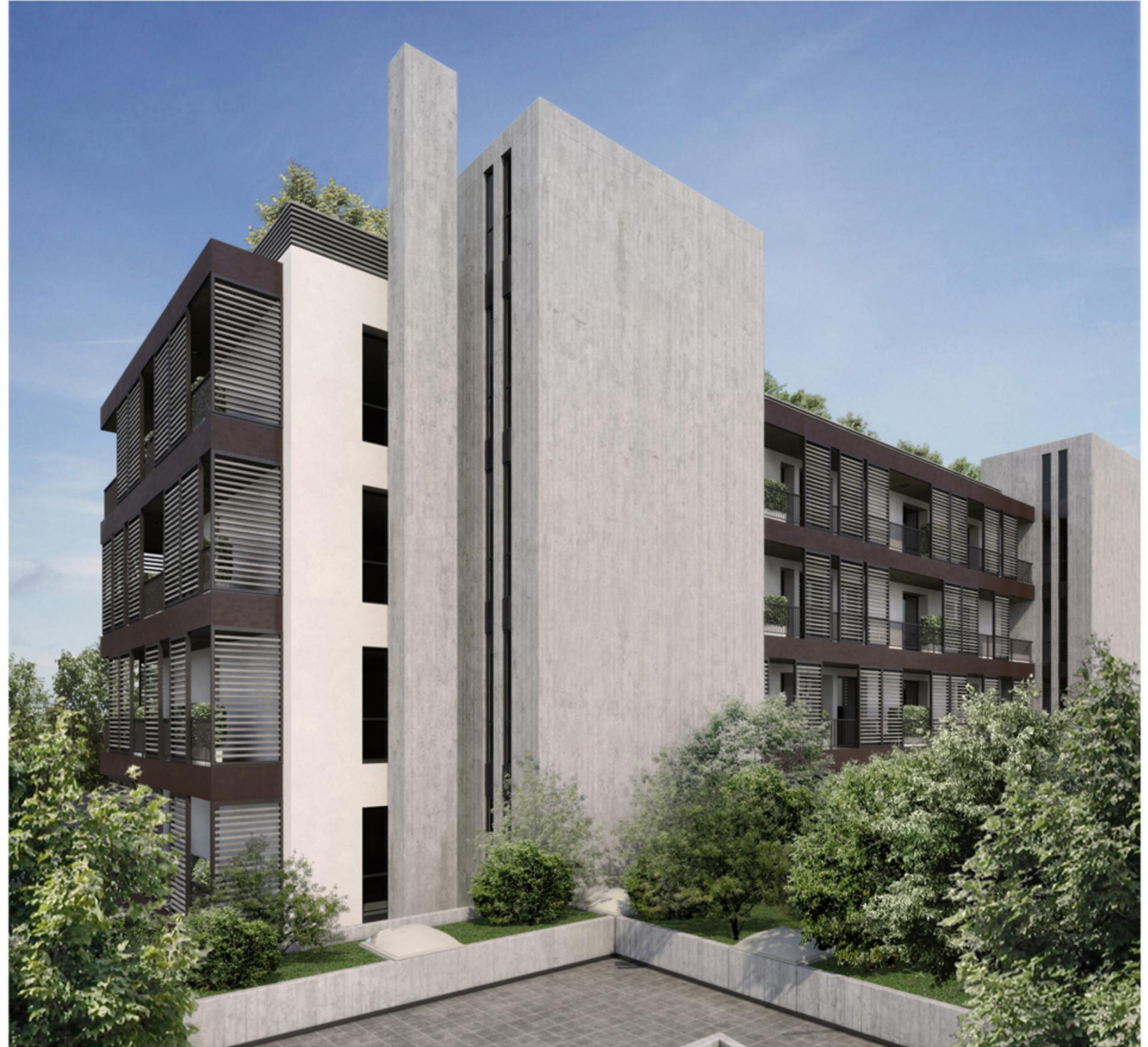
ESEMPIO DI SVILUPPO BALCONI LATO SUD CON PANNELLI BRISE SOLEIL METALLICI E PANNELLI DI CRISTALLO
